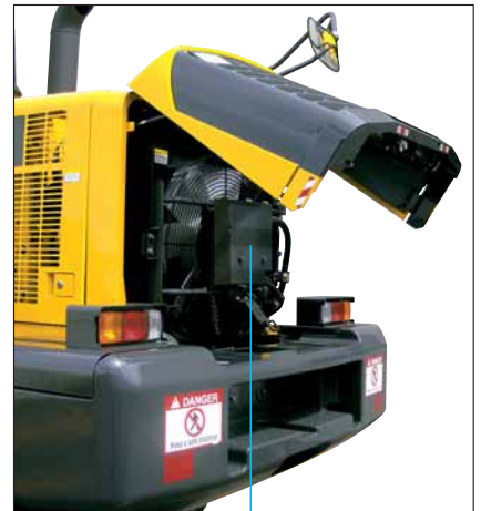
Hydraulic driven fan
